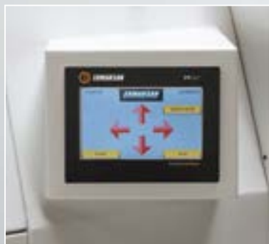
Pannello di controllo CNC sul retro della macchina: permette il controllo diretto del cambio pallet.
